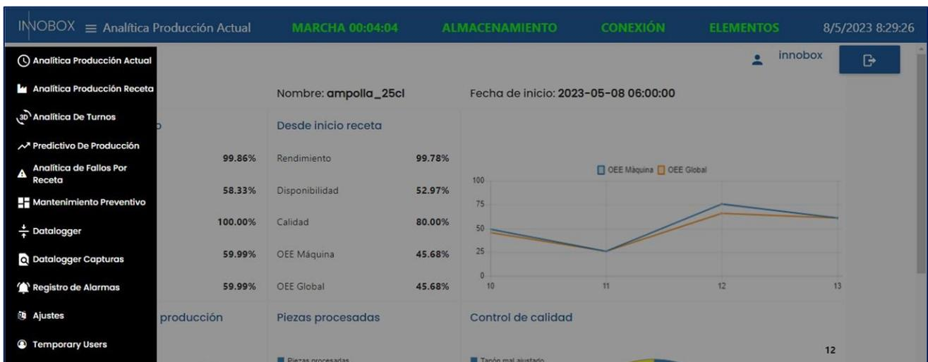
Igualmente, común a todas las pantallas, tendremos la cabecera con información rápida de la máquina, como el estado actual y el tiempo continuado en este estado, la disponibilidad de memoria del dispositivo, el estado de la conexión con el PLC y si hay alguna tarea de mantenimiento a realizar. Esta última se explicará en detalle en su apartado, pero todos los indicadores siguen la premisa de verde -> bueno, rojo -> malo.
